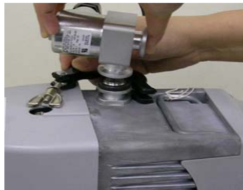
Abbildung 9 Einbau des Einlassventils in die Pumpe IDP-3
